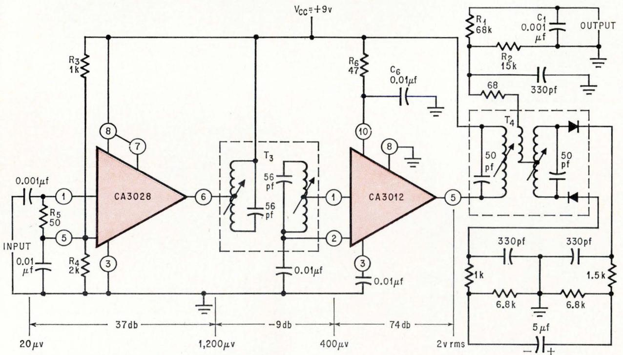
$T_3$ : INTERSTAGE TRANSFORMER TRW NO. 22486 OR EQUIVALENT
