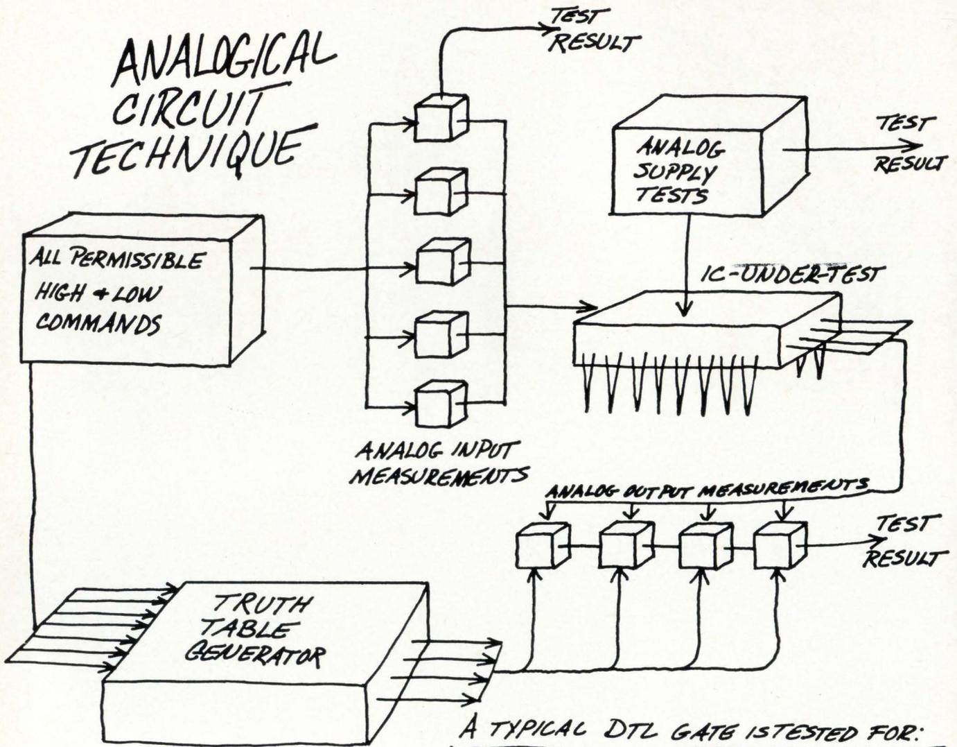
A TYPICAL DTL GATE IS TESTED FOR:
